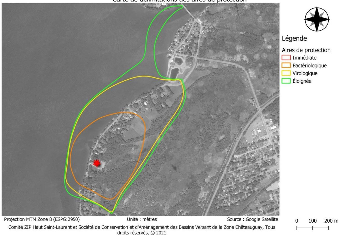
**Figure 12 - Limite des aires de protection de la prise souterraine X0010091-3**
